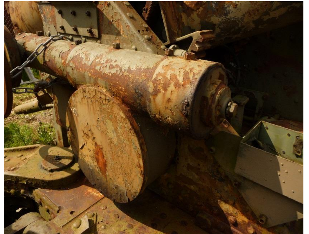
Efterkrigskanon som är målad med rostskyddsfärg (blymönja).
