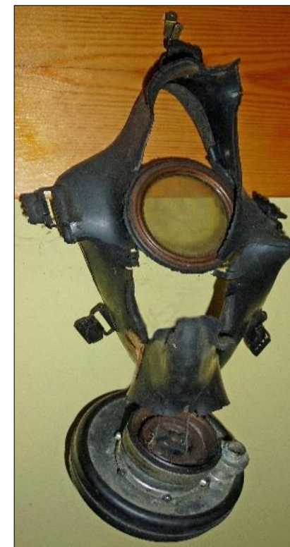
Gasmask av gummi (efterkrigsmodell) som faller sönder.
